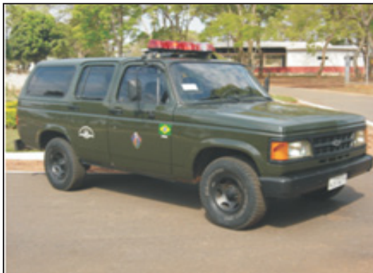
Fig 26 - Viatura para transporte e patrulhamento com cães, dotada com rotorlight , sirene, equipamentos de comunicação, farol de busca e megafone
